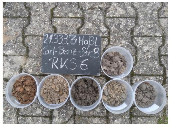
Bild 12: Bei Erkundungspunkt RKS 6 am Benzinabscheider aufgeschlossenes und beprobtes, überwiegend organoleptisch unauffälliges Bodenmaterial.
