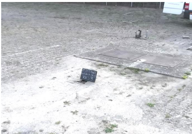
Bild 5: Der unmittelbar NW neben dem Tankdomschacht des unterflurig lagernden Kraftstofftankes abgeteufte RKS 3 im Blick nach O (Im re.Hintergrund: RKS/RP 4).
